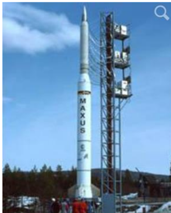
La fusée-sonde Maxus de l'ESA, elle peut embarquer jusqu'à 780 kg de matériel.
